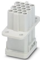
Kontakteinsatz, Polzahl: 17+PE, Baugröße: COM, Leistungskontakte: 0, Steuerkontakte: 17, Anzahl der Anschlüsse je Pol: 1, Buchse, Crimpanschluss, 200 V, 10 A, 0,14 mm<sup>2</sup> ... 2,5 mm<sup>2</sup>, Anwendung: Leistung, nur für Kunststoffgehäuse geeignet
