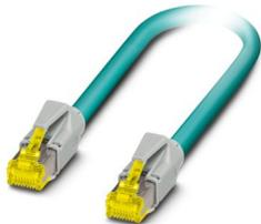
Patch-Kabel, CAT6<sub>A</sub>, 4-paarig, geschirmt, nicht gekreuzte Verbindung (Line), beidseitig konfektioniert mit RJ45/IP20-Steckverbindern, Material Außenmantel: PUR, Länge: 10 m
