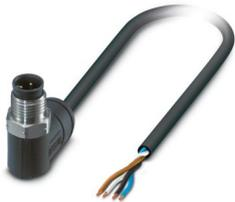
Sensor-/Aktor-Kabel, 4-polig, PE-X halogenfrei, schwarzgrau RAL 7021, Stecker gewinkelt M12, Kodierung: A, auf freies Leitungsende, Kabellänge: 10 m, für Außenanwendungen, mit Edelstahlrändel
