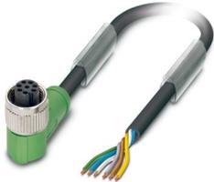
M12-Anschlussbuchse, gewinkelt, 6-polig, mit angeschlossenem Stammkabel, für Sensor-/Aktor-Box mit M8-Steckplätzen, Kabellänge: 5 m
