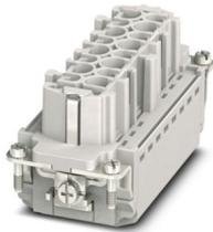
Kontakteinsatz, Polzahl: 6+2+PE, Baugröße: B16, Leistungskontakte: 6, Steuerkontakte: 2, Anzahl der Anschlüsse je Pol: 1, Buchse, Push-in-Anschluss, 690 V, 16 A, 0,14 mm<sup>2</sup> ... 2,5 mm<sup>2</sup>, Anwendung: Leistung
