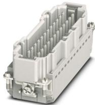
Kontakteinsatz, Polzahl: 24+PE, Baugröße: B24, Stift, Push-in-Anschluss, 500 V, 16 A, 0,14 mm<sup>2</sup> ... 2,5 mm<sup>2</sup>, Anwendung: Leistung
