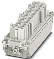
Kontakteinsatz, Polzahl: 24+PE, Baugröße: B24, Buchse, Push-in-Anschluss, 500 V, 16 A, 0,14 mm<sup>2</sup> ... 2,5 mm<sup>2</sup>, Anwendung: Leistung
