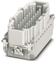
Kontakteinsatz, Polzahl: 16+PE, Baugröße: B16, Stift, Push-in-Anschluss, 500 V, 16 A, 0,14 mm<sup>2</sup> ... 2,5 mm<sup>2</sup>, Anwendung: Leistung
