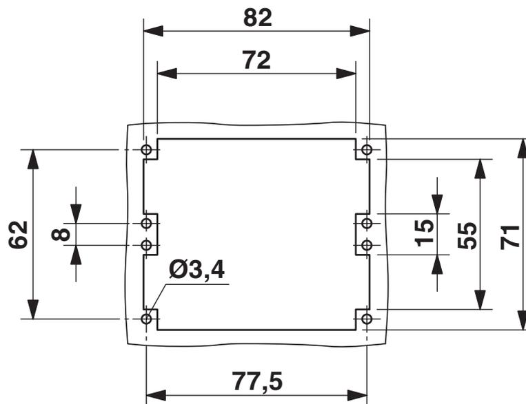
Montageausschnitt bei Verwendung ohne Gehäuse
