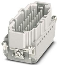
Kontakteinsatz, Polzahl: 16+PE, Baugröße: B16, Anzahl der Anschlüsse je Pol: 1, Stift, Push-in-Anschluss, 500 V, 16 A, 0,14 mm<sup>2</sup> ... 2,5 mm<sup>2</sup>, Anwendung: Leistung
