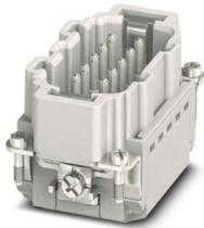
Kontakteinsatz, Polzahl: 10+PE, Baugröße: B10, Anzahl der Anschlüsse je Pol: 1, Stift, Push-in-Anschluss, 500 V, 16 A, 0,14 mm<sup>2</sup> ... 2,5 mm<sup>2</sup>, Anwendung: Leistung
