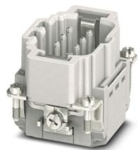
Kontakteinsatz, Polzahl: 6+PE, Baugröße: B6, Anzahl der Anschlüsse je Pol: 1, Stift, Push-in-Anschluss, 500 V, 16 A, 0,14 mm<sup>2</sup> ... 2,5 mm<sup>2</sup>, Anwendung: Leistung
