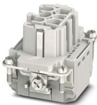
Kontakteinsatz, Polzahl: 6+PE, Baugröße: B6, Anzahl der Anschlüsse je Pol: 1, Buchse, Push-in-Anschluss, 500 V, 16 A, 0,14 mm<sup>2</sup> ... 2,5 mm<sup>2</sup>, Anwendung: Leistung
