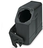
Kupplungsgehäuse B24, mit Längsbügel, Material: PA 6.6-FR, Kabelabgänge: 1, gerade/seitlich, Höhe: 90 mm, Kabelverschraubung: ohne, Standard
