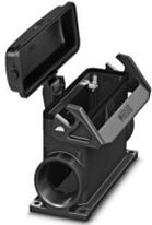
Sockelgehäuse B24, mit Längsbügel, Material: PA 6.6-FR, Material Schutzdeckel: PC, Kabelabgänge: 2, seitlich, 2x M40, Höhe: 84 mm, Kabelverschraubung: ohne, Schutzdeckel: ja, Standard
