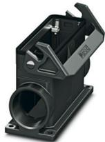
Sockelgehäuse B24, mit Längsbügel, Material: PA 6.6-FR, Kabelabgänge: 2, seitlich, 2x M40, Höhe: 84 mm, Kabelverschraubung: ohne, Standard
