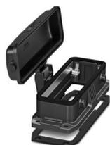
Anbaugehäuse B24, für Querbügel, Material: PA 6.6-FR, Material Schutzdeckel: PC, Höhe: 30,5 mm, Kabelverschraubung: ohne, Schutzdeckel: ja, Standard, mit Flachdichtung
