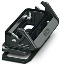
HEAVYCON EVO-Anbaugehäuse aus Kunststoff, B24, mit Längsbügel, Höhe 30,5 mm, mit Flachdichtung
