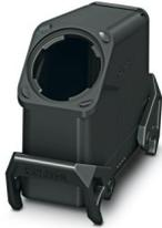
HEAVYCON EVO-Tüllengehäuse aus Kunststoff, mit Bajonettflansch für die EVO-Verschraubung, B24, mit Querbügel, Höhe 87,5 mm, ohne EVO-Verschraubung
