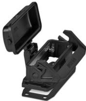
Anbaugehäuse B16, mit Längsbügel, Material: PA 6.6-FR, Material Schutzdeckel: PC, Höhe: 30,5 mm, Kabelverschraubung: ohne, Schutzdeckel: ja, Standard, mit Flachdichtung
