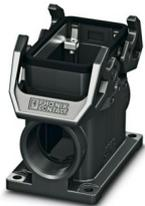
Sockelgehäuse B10, mit Querbügel, Material: PA 6.6-FR, Kabelabgänge: 2, seitlich, 2x M32, Höhe: 74 mm, Kabelverschraubung: ohne, Standard
