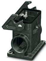
Sockelgehäuse B10, mit Längsbügel, Material: PA 6.6-FR, Kabelabgänge: 2, seitlich, 2x M32, Höhe: 74 mm, Kabelverschraubung: ohne, Standard
