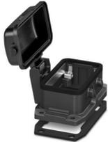
Anbaugehäuse B10, für Querbügel, Material: PA 6.6-FR, Material Schutzdeckel: PC, Höhe: 30,5 mm, Kabelverschraubung: ohne, Schutzdeckel: ja, Standard, mit Flachdichtung
