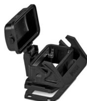
Anbaugehäuse B10, mit Längsbügel, Material: PA 6.6-FR, Material Schutzdeckel: PC, Höhe: 30,5 mm, Kabelverschraubung: ohne, Schutzdeckel: ja, Standard, mit Flachdichtung
