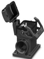
Sockelgehäuse B6, mit Längsbügel, Material: PA 6.6-FR, Material Schutzdeckel: PC, Kabelabgänge: 2, seitlich, 2x M32, Höhe: 74 mm, Kabelverschraubung: ohne, Schutzdeckel: ja, Standard
