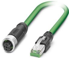
Netzwerkkabel, PROFINET CAT5 (100 MBit/s), EtherCAT® CAT5 (100 MBit/s), 4-polig, PVC/PVC, grün RAL 6018, geschirmt (Advanced Shielding Technology), Buchse gerade M12, Kodierung: D / IP67, auf Stecker gerade RJ45 / IP20, Kabellänge: 1 m
