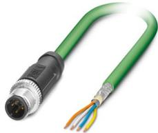
Netzwirkkabel, PROFINET CAT5 (100 MBit/s), EtherCAT® CAT5 (100 MBit/s), 4-polig, PVC/PVC, grün RAL 6018, geschirmt (Advanced Shielding Technology), Stecker gerade M12, Kodierung: D / IP67, auf freies Leitungsende, Kabellänge: 5 m
