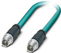
Netzwerkkabel, Ethernet CAT6<sub>A</sub> (10 GBit/s), CC-Link IE CAT6<sub>A</sub> (10 GBit/s), 8-polig, PUR halogenfrei, wasserblau RAL 5021, geschirmt (Advanced Shielding Technology), Stecker gerade M12, Kodierung: X / IP67, auf Stecker gerade M12, Kodierung: X / IP67, Kabellänge: 1 m
