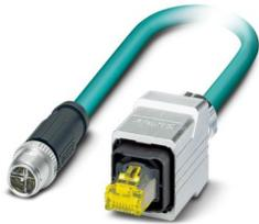
Netzwerkkabel, Ethernet CAT6<sub>A</sub> (10 GBit/s), CC-Link IE CAT6<sub>A</sub> (10 GBit/s), 8-polig, PUR halogenfrei, wasserblau RAL 5021, geschirmt (Advanced Shielding Technology), Stecker gerade M12 SPEEDCON, Kodierung: X / IP67, auf Stecker gerade RJ45 Push-Pull / IP67, Kabellänge: 10 m
