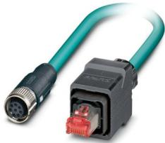
Netzwerkkabel, Ethernet CAT5 (1 GBit/s), 8-polig, PUR halogenfrei, wasserblau RAL 5021, geschirmt, Stecker gerade RJ45 Push-Pull / IP67, auf Buchse gerade M12 SPEEDCON, Kodierung: A / IP67, Kabellänge: 10 m
