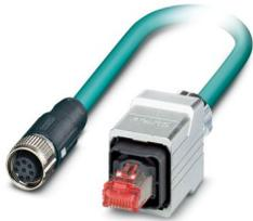
Netzwerkkabel, Ethernet CAT5 (1 GBit/s), 8-polig, PUR halogenfrei, wasserblau RAL 5021, geschirmt, Stecker gerade RJ45 Push-Pull / IP67, auf Buchse gerade M12 SPEEDCON, Kodierung: A / IP67, Kabellänge: 5 m
