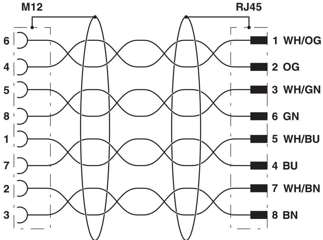
Kontaktbelegung der M12-Buchse und des RJ45-Steckers
