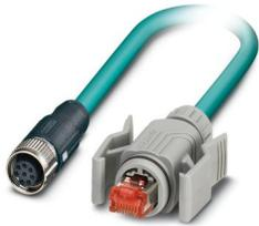
Netzwerkkabel, Ethernet CAT5 (1 GBit/s), 8-polig, PUR halogenfrei, wasserblau RAL 5021, geschirmt, Stecker gerade RJ45 Clipverriegelung / IP67, auf Buchse gerade M12 SPEEDCON, Kodierung: A / IP67, Kabellänge: 10 m
