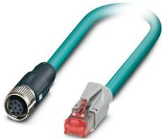
Netzwerkkabel, Ethernet CAT5 (1 GBit/s), 8-polig, PUR halogenfrei, wasserblau RAL 5021, geschirmt, Stecker gerade RJ45 / IP20, auf Buchse gerade M12 SPEEDCON, Kodierung: A / IP67, Kabellänge: 2 m
