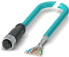
Netzwirkabel, Ethernet CAT5 (1 GBit/s), 8-polig, PUR halogenfrei, wasserblau RAL 5021, geschirmt (Advanced Shielding Technology), freies Leitungsende, auf Buchse gerade M12, Kodierung: A / IP67, Kabellänge: 5 m
