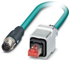
Netzwerkkabel, Ethernet CAT5 (1 GBit/s), 8-polig, PUR halogenfrei, wasserblau RAL 5021, geschirmt, Stecker gerade M12 SPEEDCON, Kodierung: A / IP67, auf Stecker gerade RJ45 Push-Pull / IP67, Kabellänge: 5 m
