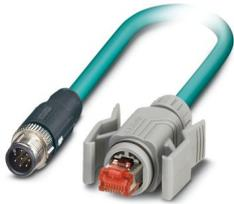
Netzwerkkabel, Ethernet CAT5 (1 GBit/s), 8-polig, PUR halogenfrei, wasserblau RAL 5021, geschirmt, Stecker gerade M12 SPEEDCON, Kodierung: A / IP67, auf Stecker gerade RJ45 Clipverriegelung / IP67, Kabellänge: 2 m
