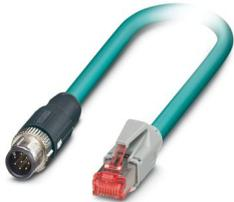
Netzwerkkabel, Ethernet CAT5 (1 GBit/s), 8-polig, PUR halogenfrei, wasserblau RAL 5021, geschirmt (Advanced Shielding Technology), Stecker gerade M12, Kodierung: A / IP67, auf Stecker gerade RJ45 / IP20, Kabellänge: 10 m
