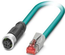
Netzwerkkabel, Ethernet CAT5 (100 MBit/s), 4-polig, PUR halogenfrei, wasserblau RAL 5021, geschirmt (Advanced Shielding Technology), Buchse gerade M12, Kodierung: D / IP67, auf Stecker gerade RJ45 / IP20, Kabellänge: 10 m
