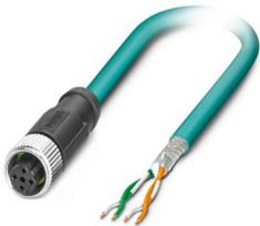
Netzwerkkabel, Ethernet CAT5 (100 MBit/s), 4-polig, PUR halogenfrei, wasserblau RAL 5021, geschirmt (Advanced Shielding Technology), freies Leitungsende, auf Buchse gerade M12, Kodierung: D / IP67, Kabellänge: 1 m
