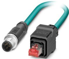
Netzwerkkabel, Ethernet CAT5 (100 MBit/s), 4-polig, PUR halogenfrei, wasserblau RAL 5021, geschirmt (Advanced Shielding Technology), Stecker gerade M12, Kodierung: D / IP67, auf Stecker gerade RJ45 Push-Pull / IP67, Kabellänge: 5 m
