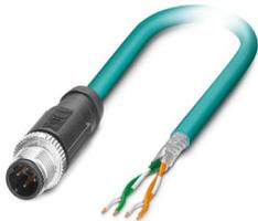
Netzwirkkabel, Ethernet CAT5 (100 MBit/s), 4-polig, PUR halogenfrei, wasserblau RAL 5021, geschirmt (Advanced Shielding Technology), Stecker gerade M12, Kodierung: D / IP67, auf freies Leitungsende, Kabellänge: 5 m
