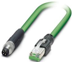
Netzwerkkabel, Ethernet (100 MBit/s), PROFINET (100 MBit/s), EtherCAT® (100 MBit/s), 4-polig, PVC/PVC, grün RAL 6018, geschirmt, Stecker gerade M8, Kodierung: A / IP67, auf Stecker gerade RJ45 / IP20, Kabellänge: 2 m
