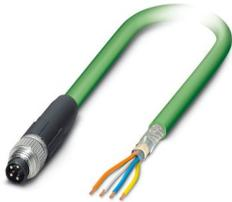
Netzwerkkabel, Ethernet (100 MBit/s), PROFINET (100 MBit/s), EtherCAT® (100 MBit/s), 4-polig, PVC/PVC, grün RAL 6018, geschirmt, Stecker gerade M8, Kodierung: A / IP67, auf freies Leitungsende, Kabellänge: 2 m
