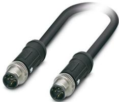
Netzwerkkabel, PROFINET CAT5 (100 MBit/s), Ethernet CAT5 (100 MBit/s), 4-polig, PE-X halogenfrei, schwarz RAL 9005, geschirmt, Stecker gerade M12 SPEEDCON, Kodierung: D / IP65, auf Stecker gerade M12 SPEEDCON, Kodierung: D / IP65, Kabellänge: 5 m, für Bahnanwendungen
