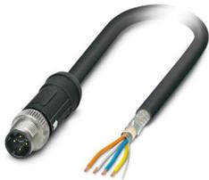
Netzkabel, PROFINET CAT5 (100 MBit/s), Ethernet CAT5 (100 MBit/s), 4-polig, PE-X halogenfrei, schwarz RAL 9005, geschirmt, Stecker gerade M12 SPEEDCON, Kodierung: D / IP65, auf freies Leitungsende, Kabellänge: 10 m, für Bahnanwendungen
