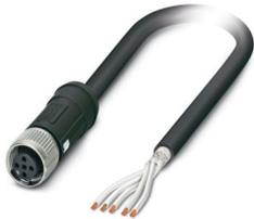
Sensor-/Aktor-Kabel, 5-polig, PE-X halogenfrei, schwarz, geschirmt, freies Leitungsende, auf Buchse gerade M12 SPEEDCON, Kodierung: A, Kabellänge: 10 m, für Bahnanwendungen
