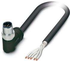
Sensor-/Aktor-Kabel, 5-polig, PE-X halogenfrei, schwarz, geschirmt, Stecker gewinkelt M12 SPEEDCON, Kodierung: A, auf freies Leitungsende, Kabellänge: 10 m, für Bahnanwendungen
