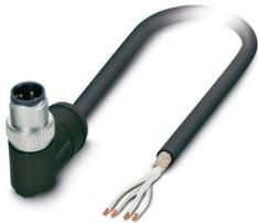
Sensor-/Aktor-Kabel, 4-polig, PE-X halogenfrei, schwarz RAL 9005, geschirmt, Stecker gewinkelt M12 SPEEDCON, Kodierung: A, auf freies Leitungsende, Kabellänge: 5 m, für Bahnanwendungen
