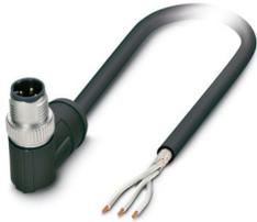
Sensor-/Aktor-Kabel, 3-polig, PE-X halogenfrei, schwarz, geschirmt, Stecker gewinkelt M12 SPEEDCON, Kodierung: A, auf freies Leitungsende, Kabellänge: 2 m, für Bahnanwendungen
