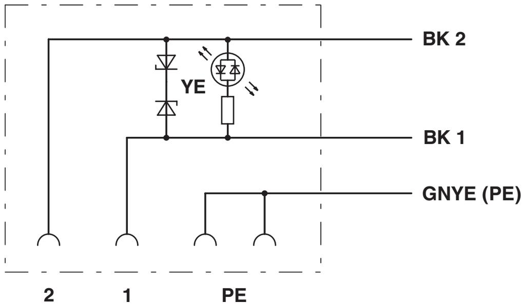
Kontaktbelegung des Ventilsteckers
