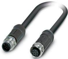
Sensor-/Aktor-Kabel, 8-polig, PE-X halogenfrei, schwarzgrau RAL 7021, Stecker gerade M12, Kodierung: A, auf Buchse gerade M12, Kodierung: A, Kabellänge: 5 m, für Außenanwendungen, mit Edelstahlrändel
