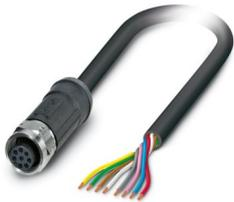
Sensor-/Aktor-Kabel, 8-polig, PE-X halogenfrei, schwarzgrau RAL 7021, freies Leitungsende, auf Buchse gerade M12, Kodierung: A, Kabellänge: 2 m, für Außenanwendungen, mit Edelstahlrändel
